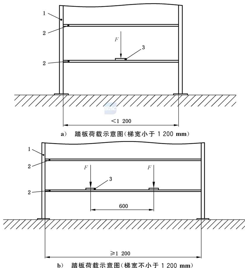
图 4 斜梯的踏板荷载示意图
