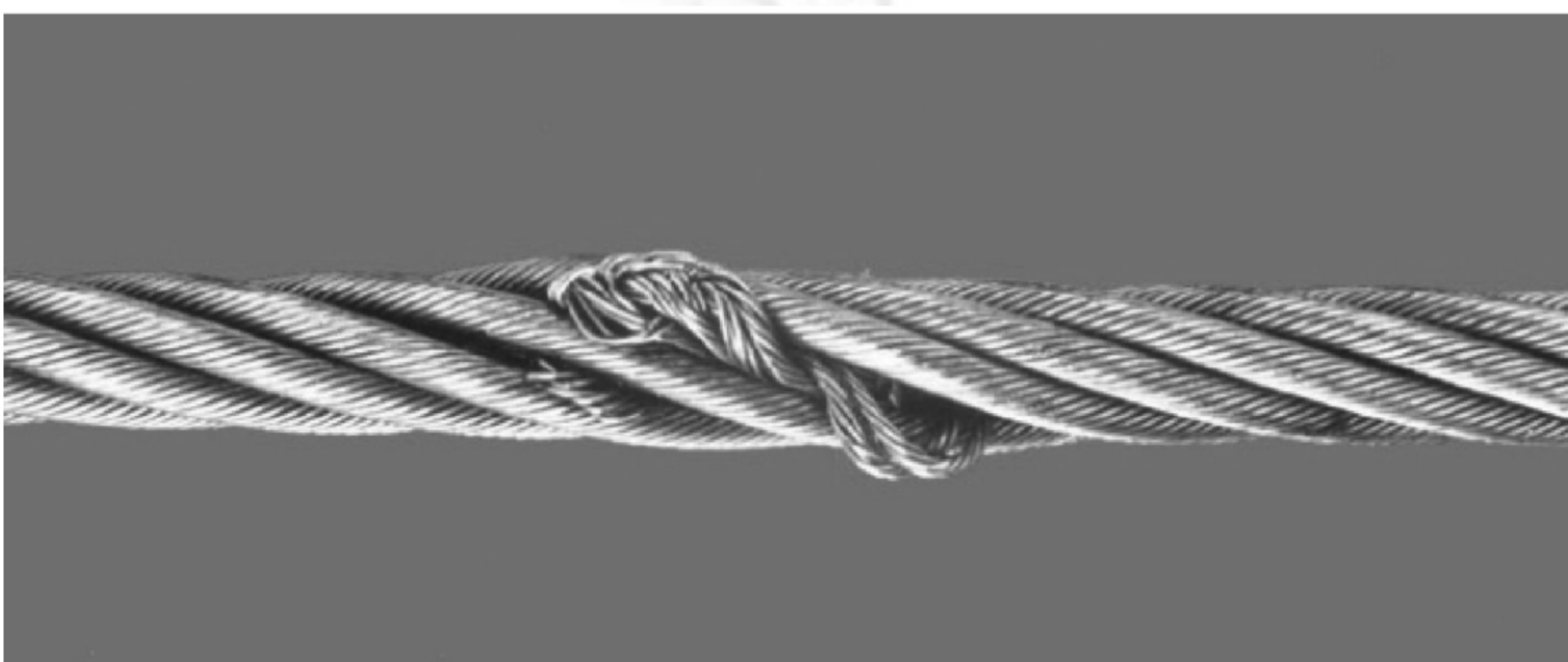
图 B.11 绳芯突出——单层钢丝绳
