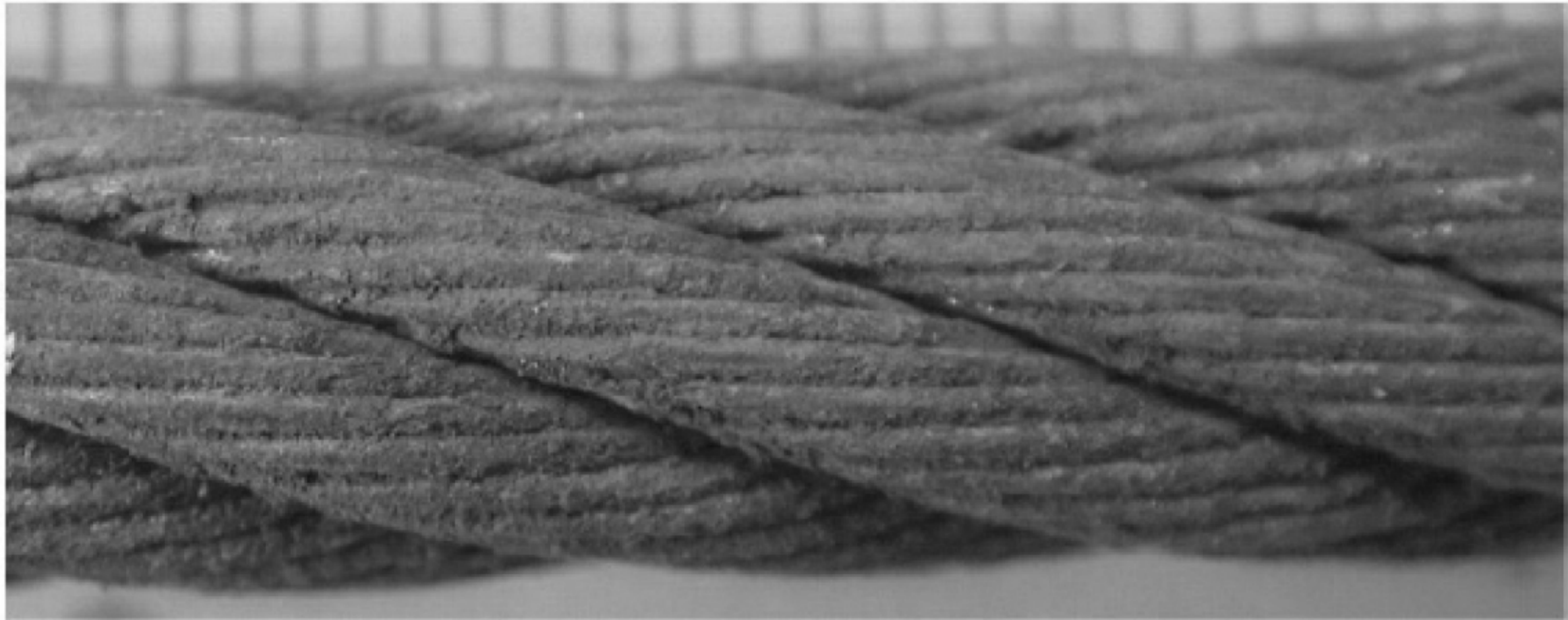
图 I.2 钢丝表面手感粗糙,普通的表面氧化——趋于报废的严重程度级别 20%
