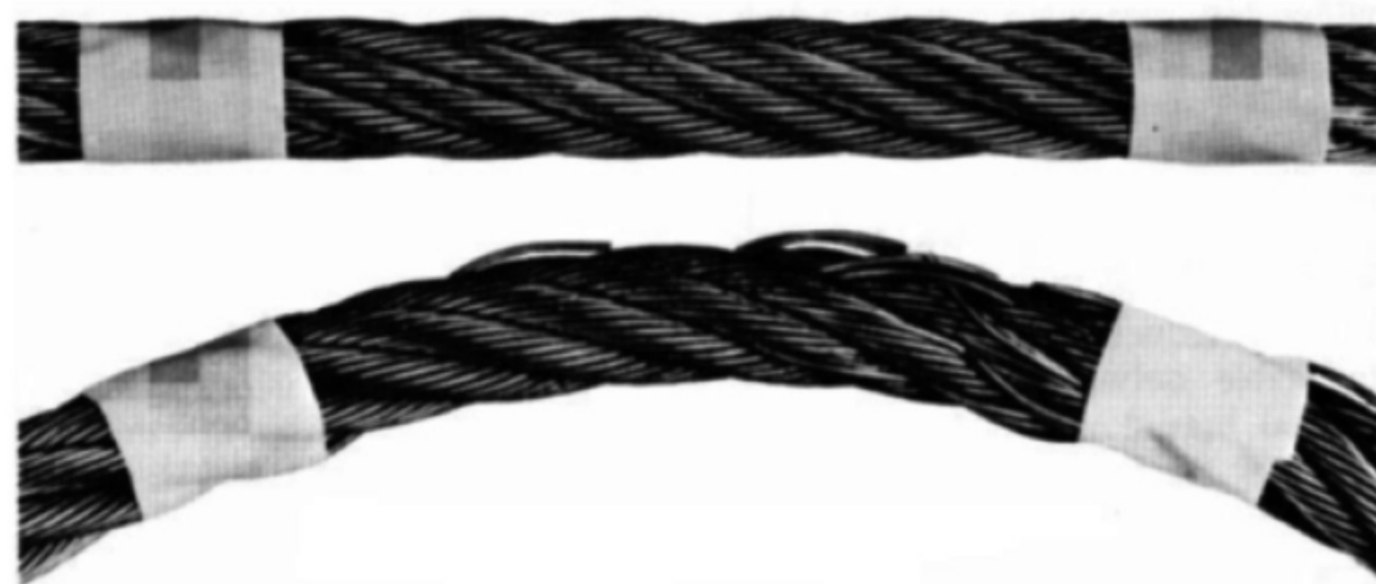
图8 弯曲钢丝绳常常会暴露出隐藏在绳股之间股沟内的断丝
