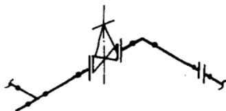
图 5.2.5 管道轴测图中阀门、管件的相对位置
