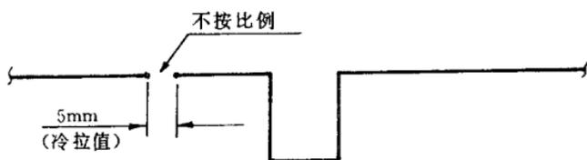
图 4.4.3-3 管道冷拉示意图
