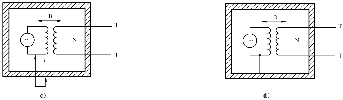
图 D.2c)和 d) 正常条件下不超过 6.3.2 限值的次级电路的可触及端子对初级危险带电电路的防护
