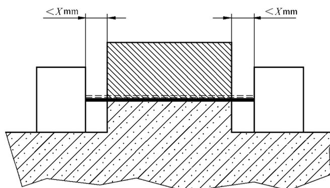
例 5 所测量的路径包含一条未粘合的接缝,该接缝的两侧各有一条宽度小于  $X$  的沟槽。
