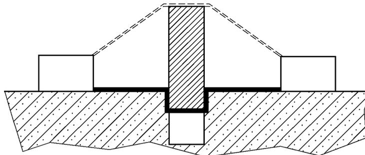
例 8 通过未粘合接缝的爬电距离小于越过挡板的爬电距离。
