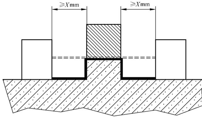
例 6 所测量的路径包含一条未粘合的接缝,该接缝的两侧各有一条宽度大于或等于  $X$  的沟槽。
