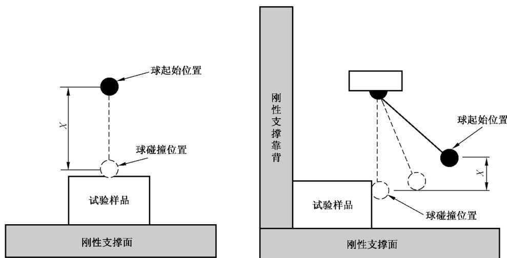
图 3 使用钢球的撞击试验
