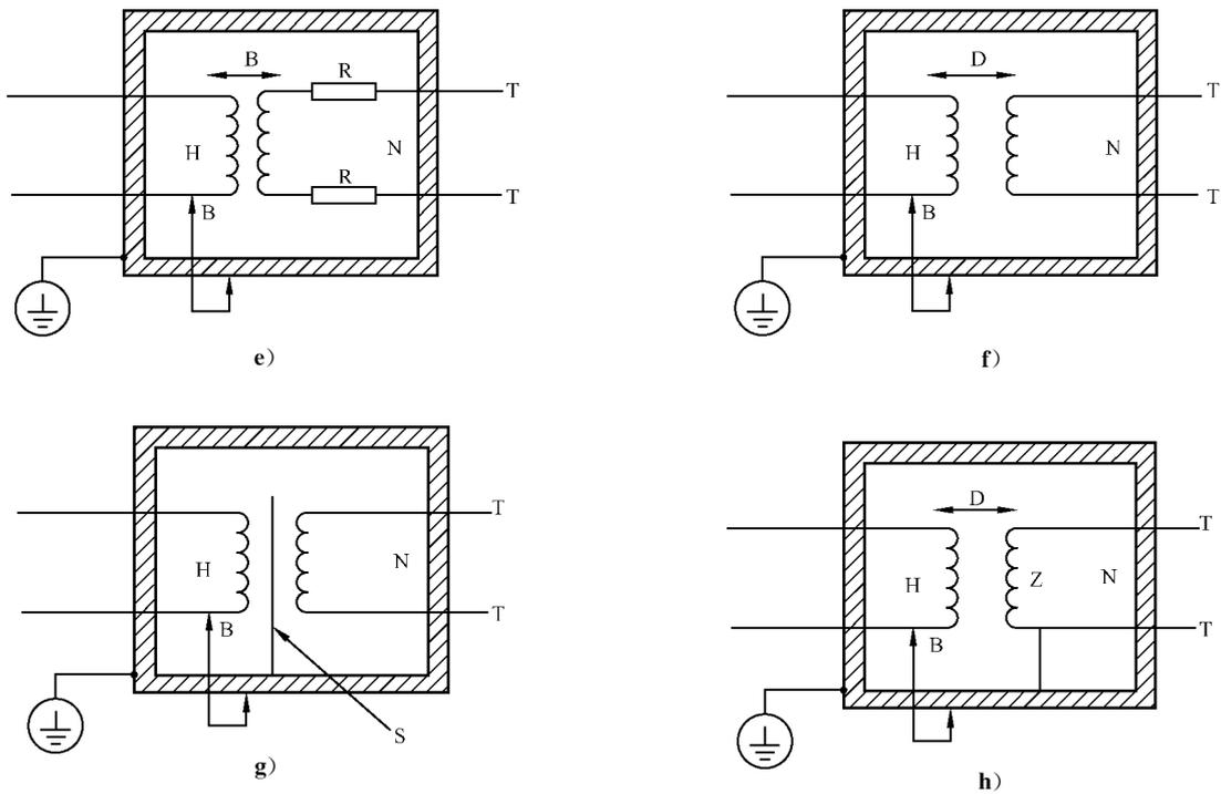
图 D.1e)~h) 危险带电电路与正常条件下不超过 6.3.2 限值且具有外部端子的其他电路之间的防护
