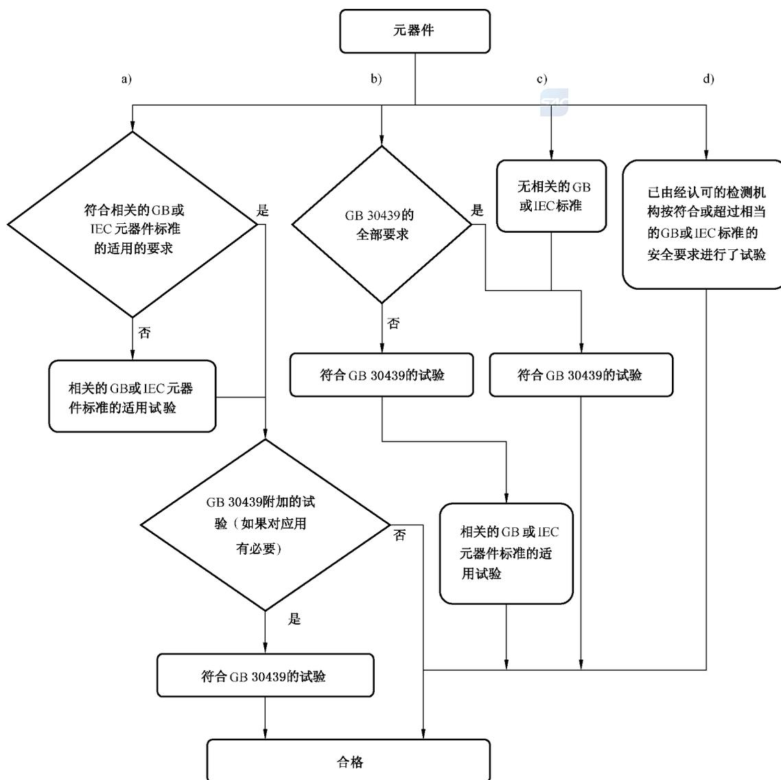
图 5 符合性选项 14.1a)、b)、c)和 d)的流程图
