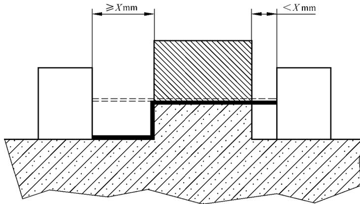
例 7 所测量的路径包含一条未粘合的接缝,该接缝的一侧有一条宽度小于  $X$  的沟槽,另一侧有一条宽度等于或大于  $X$  的沟槽。
