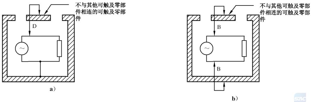
图 D.2a)和 b) 不与其他可触及零部件相连的可触及及件对内部危险带电电路的防护
