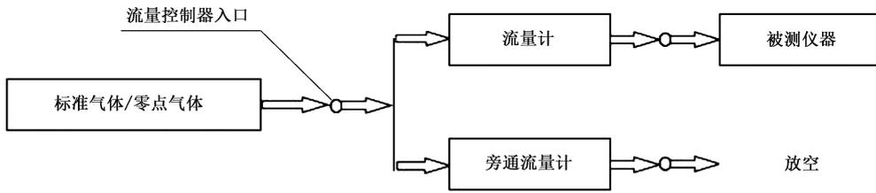
图 B.1 试验气路连接示意图
