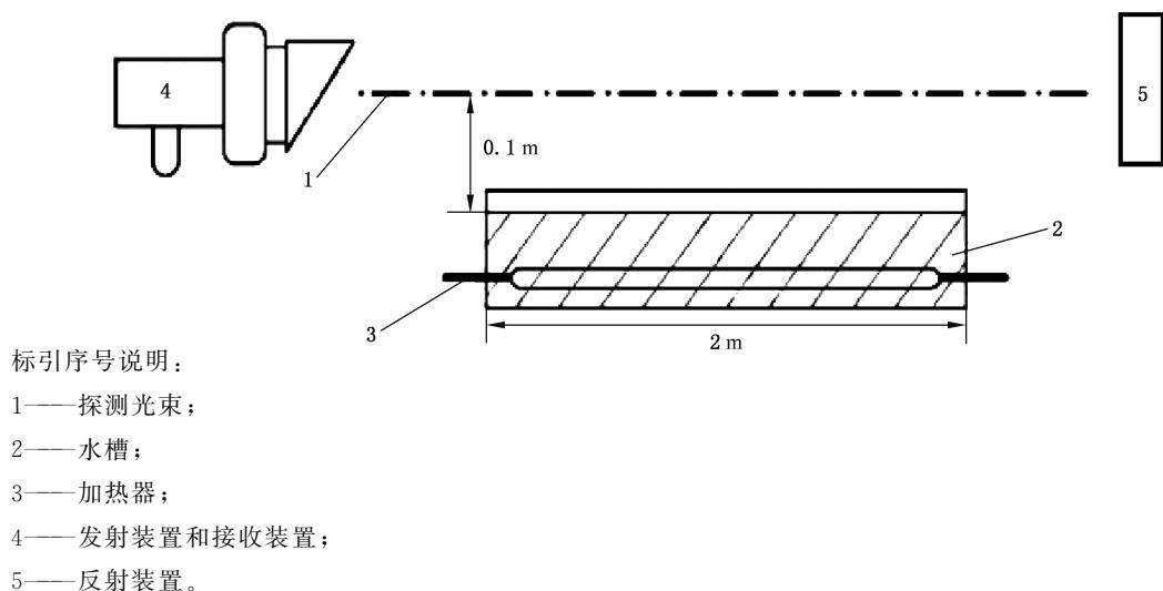
图 D.2 蒸汽干扰试验布置图(反射式)
