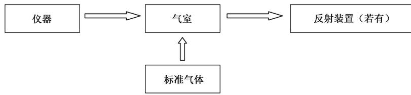
图 C.1 试验仪器连接示意图
