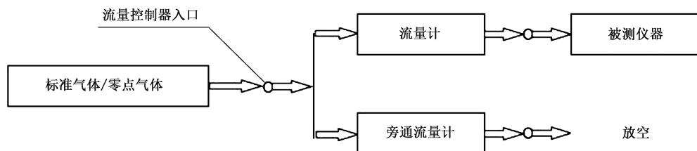
图 B.1 试验气路连接示意图
