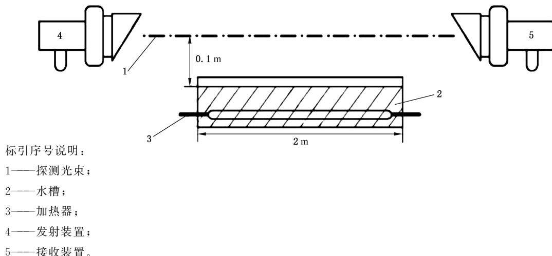
图 D.1 蒸汽干扰试验布置图(对射式)
