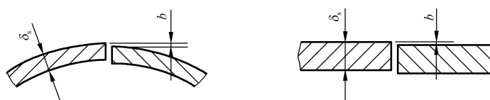
图 3 A类、B类焊接接头对口错边量示意图
