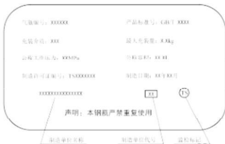
图 D-7 工业用非重复充装焊接钢瓶制造标志的项目和排列
