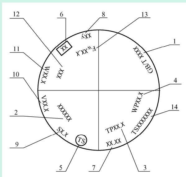
图 D-3 气瓶制造钢印的项目和排列
