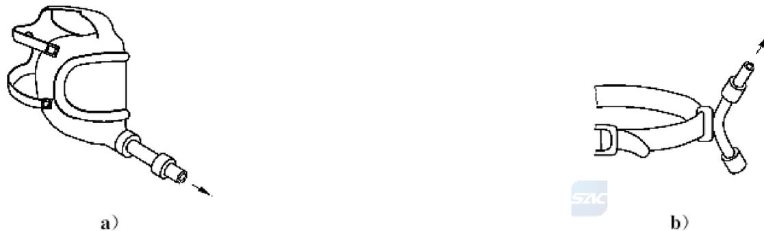
图 2 呼吸导管的连接强度检测示意图
