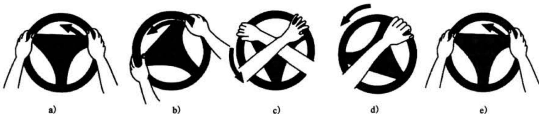
图3 向左大幅度转动转向盘的规范操作方法
