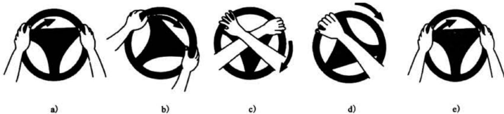
图4 向右大幅度转动转向盘的规范操作方法
