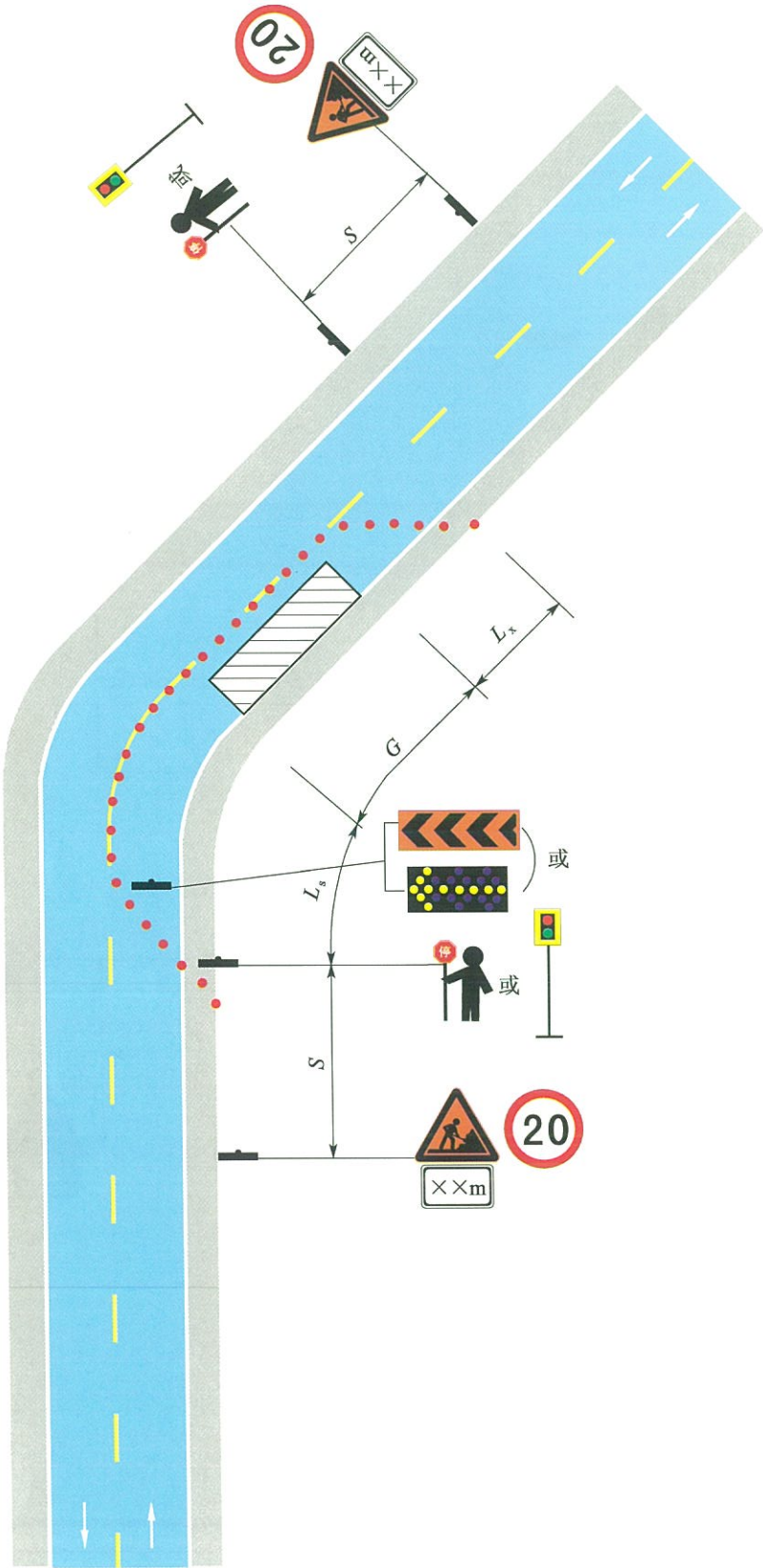
图 7.2.6-3 二、三级公路弯道路段临时养护作业
