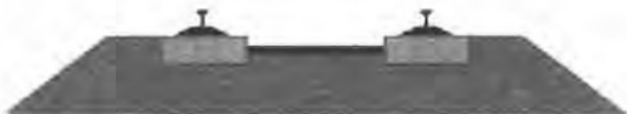
图 6 有砟道床梯形轨枕轨道断面
