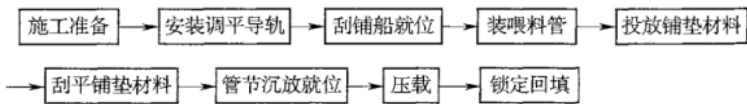
图 9.4.7 利用导轨刮平垫层的先铺法施工工艺流程
