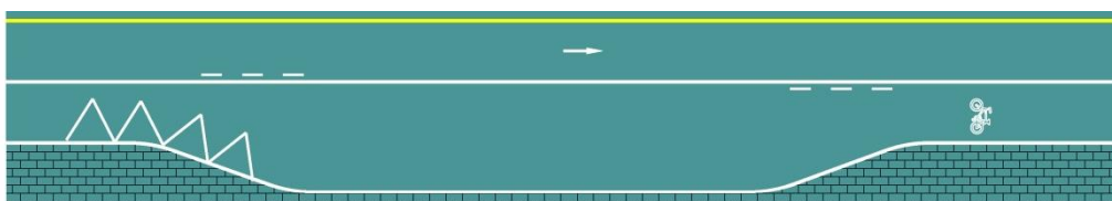
图 91 非机动车道边缘港湾式停靠站设置示例
