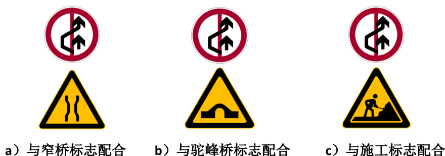
图 31 禁止超车标志与警告标志配合使用的设置
