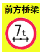
图 38 限制质量、限制轴重标志套用于荧光黄色底板上
