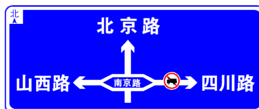
图 52 禁止某车种通行标志结合箭头杆套用
