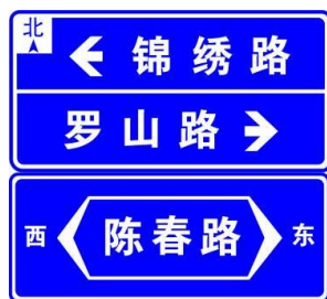
图 46 在Ⅲ类版面上方拼接左右转通达道路的信息
