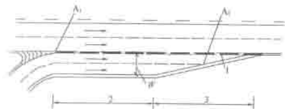
图 5.3.5-12 双车道匝道平行式入口 A_1 —汇流点; A_2 —汇合点; W —双车道宽; 1—路缘带; 2—加速段; 3—渐变段
