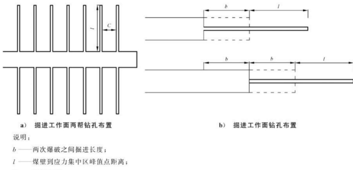
图 1 挖进工作面卸压爆破钻孔布置示意图
