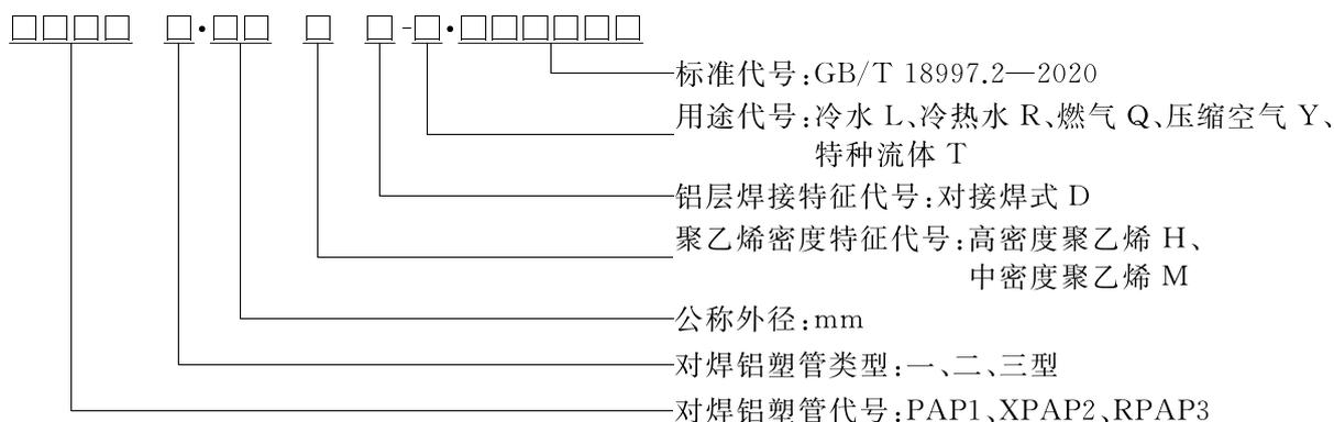
示例:一种内外层为高密度交联聚乙烯塑料,嵌入金属层为对接焊铝管的二型管,公称外径 20 mm,作冷热水输送用铝塑管,标记为:XPAP2·20HD-R·GB/T 18997.2—2020
