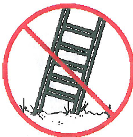
图 A.7 架设在坚实的承载面上
