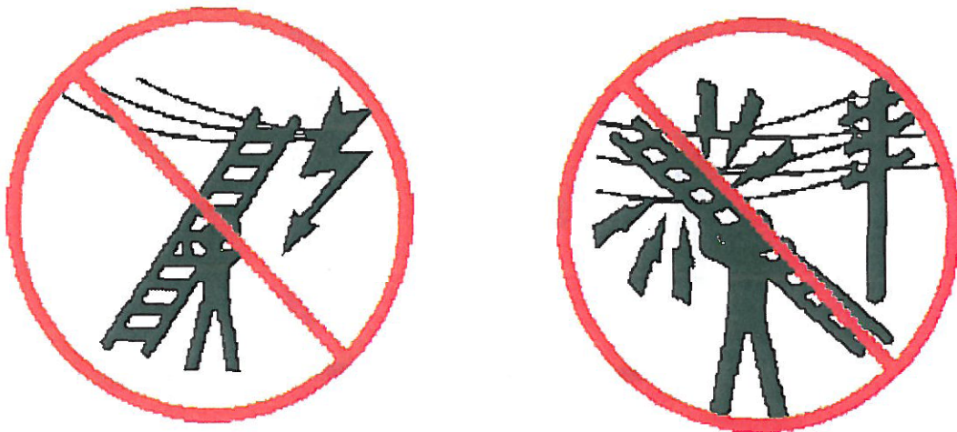
图 A.15 搬运梯子时应注意电气危险
