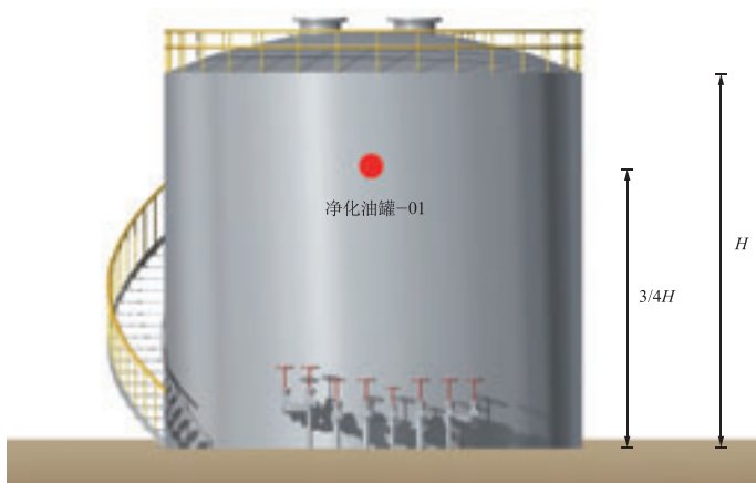
图 C.2-1 带图标标识的拱顶储罐（内浮顶储罐）
