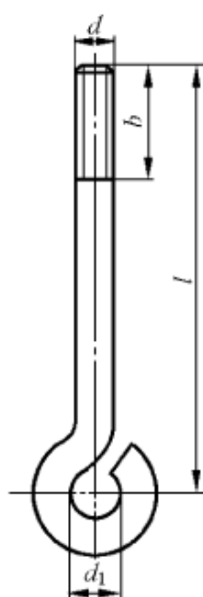
图3 开口环眼单头螺纹吊杆
