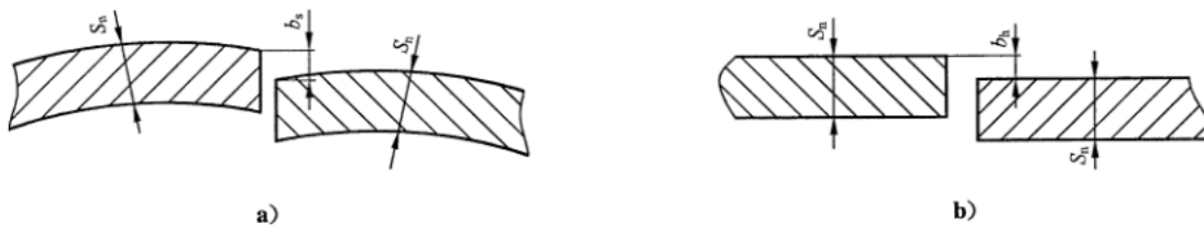
图 1 纵缝、环缝的对口错边量
