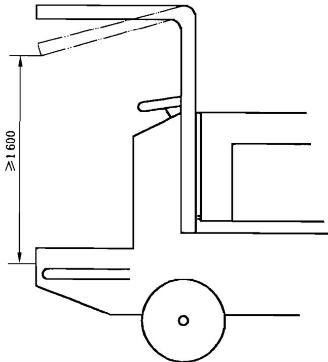
图 6 冲击试验允许变形——站驾式车辆
