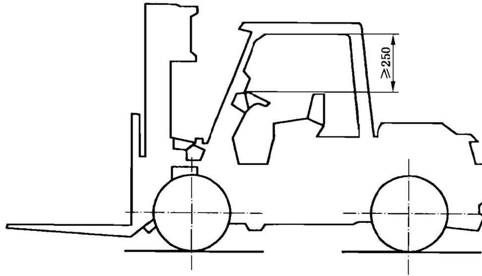
图 5 冲击试验允许变形——坐驾式车辆
