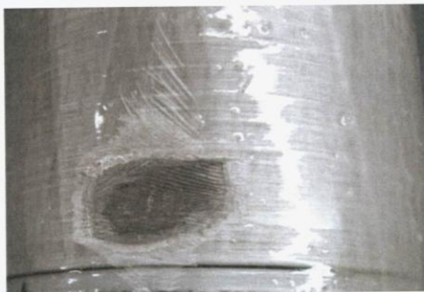
图 B.3 磨损(二级损伤)
