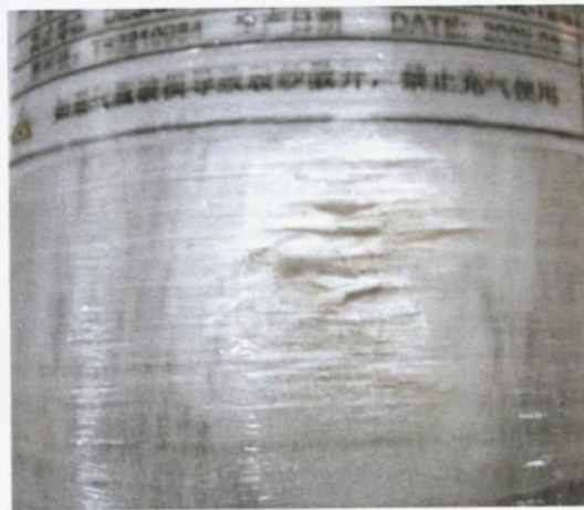
图 B.9 冲击损伤(二级损伤)
