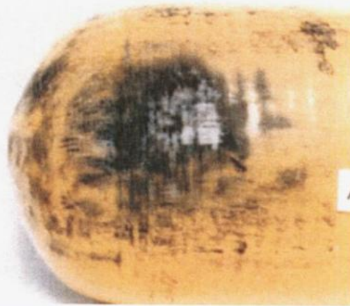
图 B.12 过热损伤(三级损伤)
