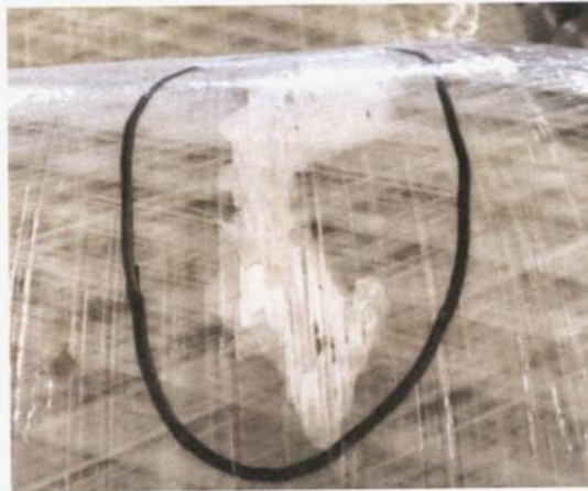
图 B.9 冲击损伤(二级损伤)
