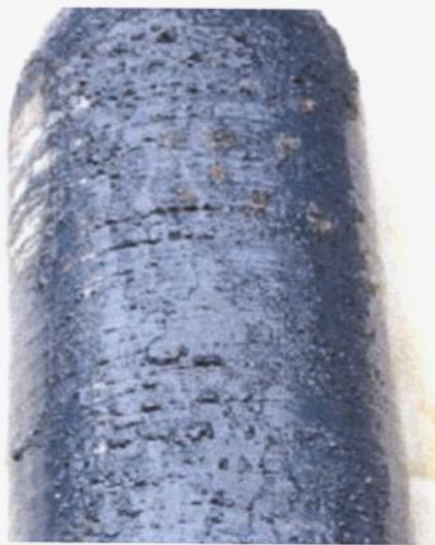
图 B.1 化学腐蚀(三级损伤)
