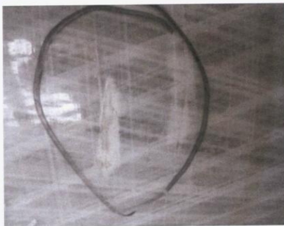
图 B.4 磨损(三级损伤)
