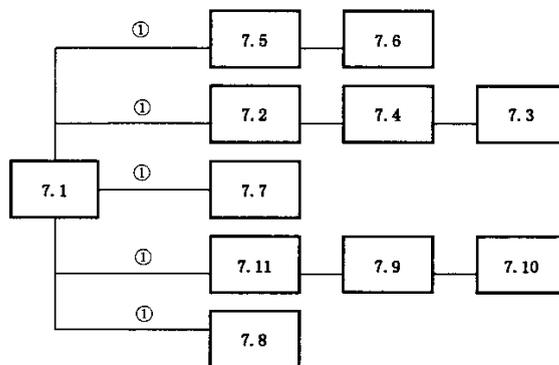
说明:方框中的数字表示试验序号,圆圈中的数字为试验所需试件数。
