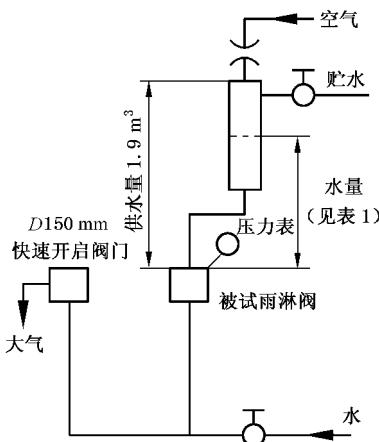
图 3 防复位试验
