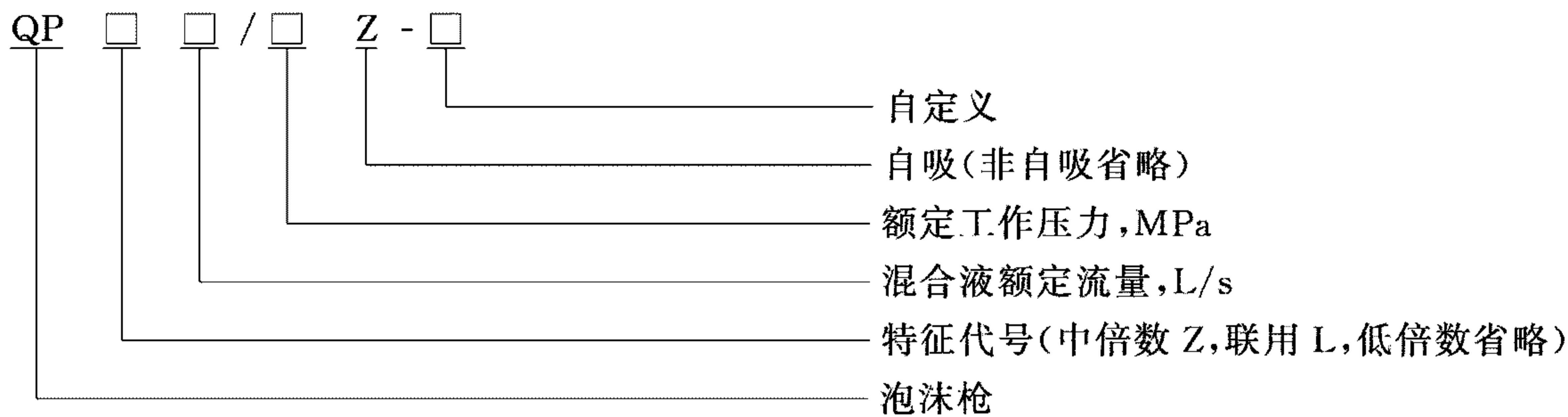
示例: 混合液额定流量为 4 L/s, 额定工作压力为 0.7 MPa 的自吸低倍数泡沫枪其型号为: QP4/0.7Z。
