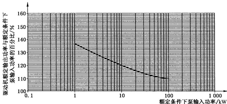
图 2 驱动机额定输出功率与额定条件下泵输入功率的百分比
