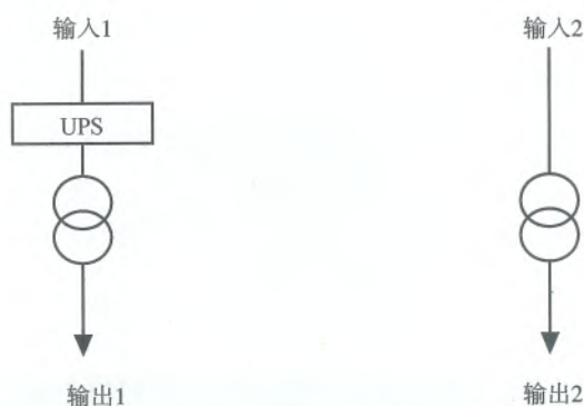
图 6.2.1 单 UPS+GPS 双输出回路供电方案
