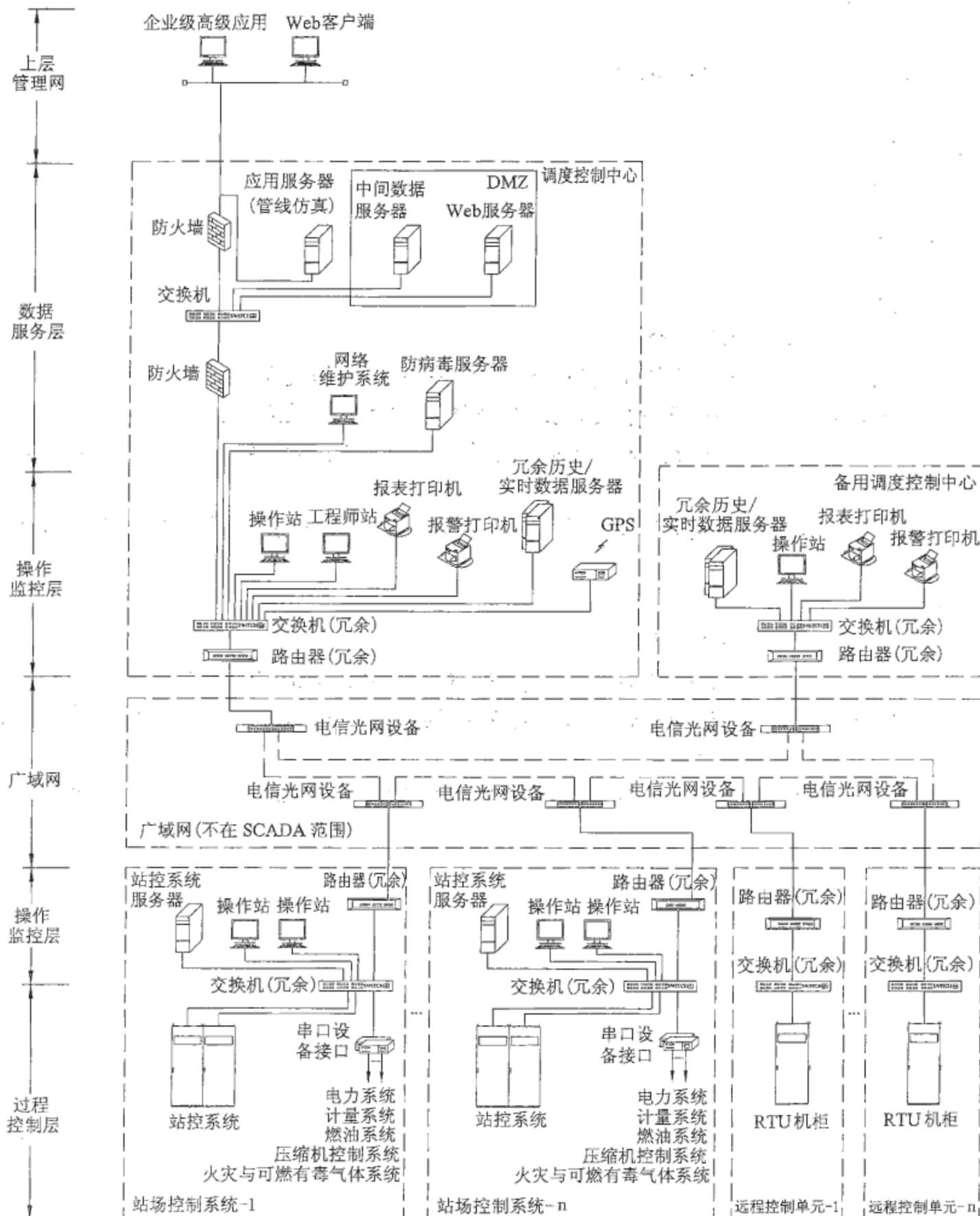
图A. 1 输油输气管道SCADA结构示意(一)
