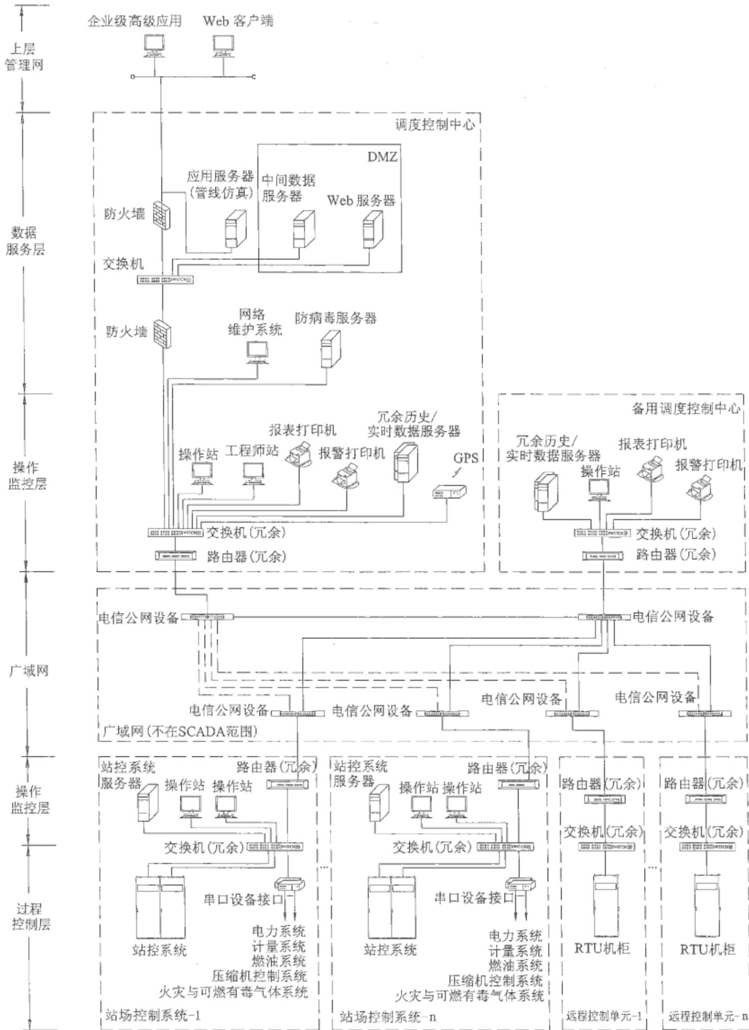
图A.2 输油输气管道SCADA结构示意图(二)
