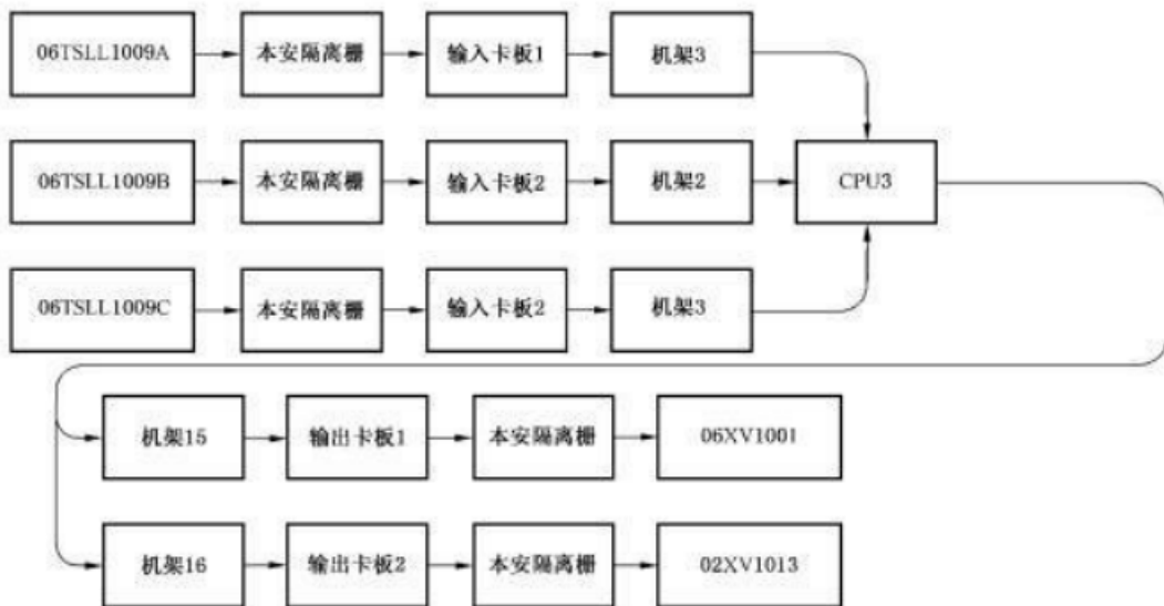
图 B. 8 SIF06.02硬件物理架构
