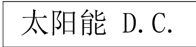
图 C.712.1 PV 方阵汇流箱上所需符号示例 (712.514.102)
