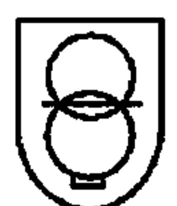
耐短路(固有型的和非固有型的)安全隔离变压器(GB 19212.7)
