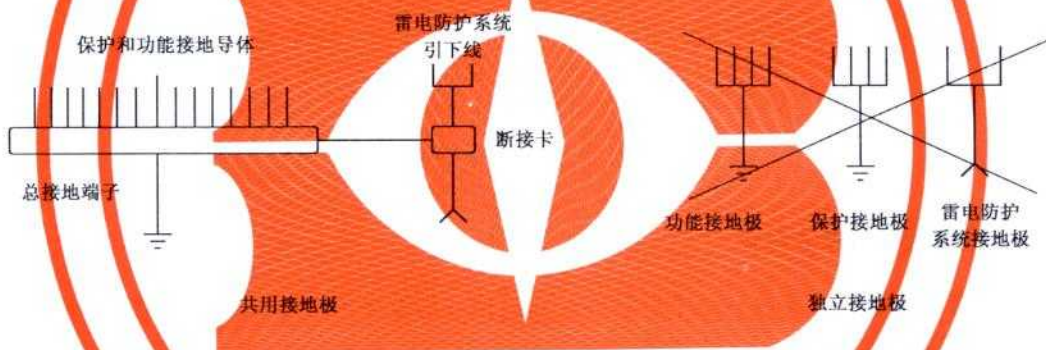
图 44. R12 相互连接的接地极
