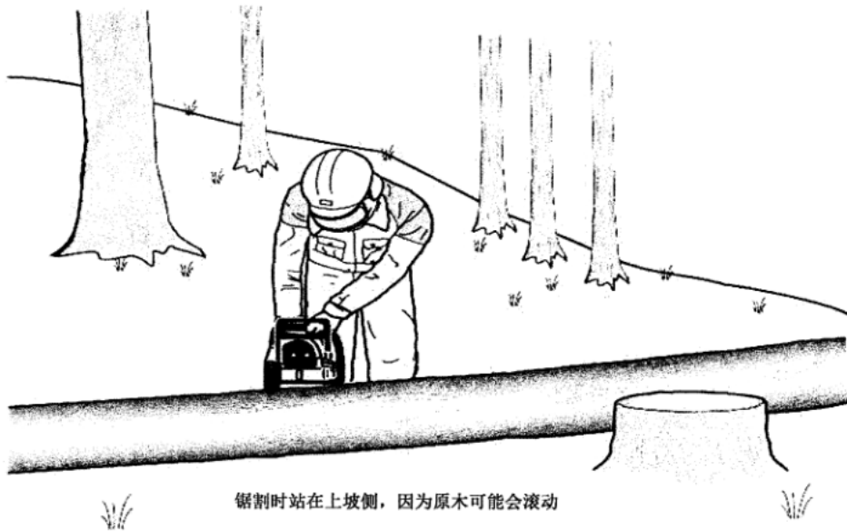
图 BB.106 两端受支撑的原木
