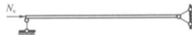
图 5.2.7 连墙件计算简图
