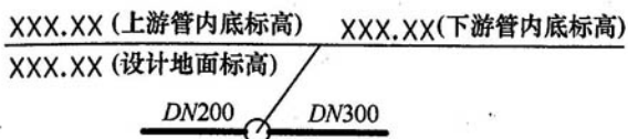
图 4.4.3-2 检查井上、下游管道的管径有变化 或有跌水时管道标高标注
