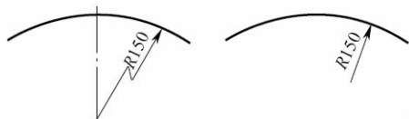
图 11.4.3 大圆弧半径的标注方法
