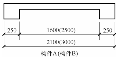
图 11.7.5 相似构件尺寸标注方法
