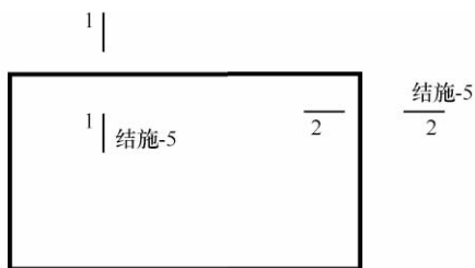
图 7.1.4-2 断面的剖切符号
