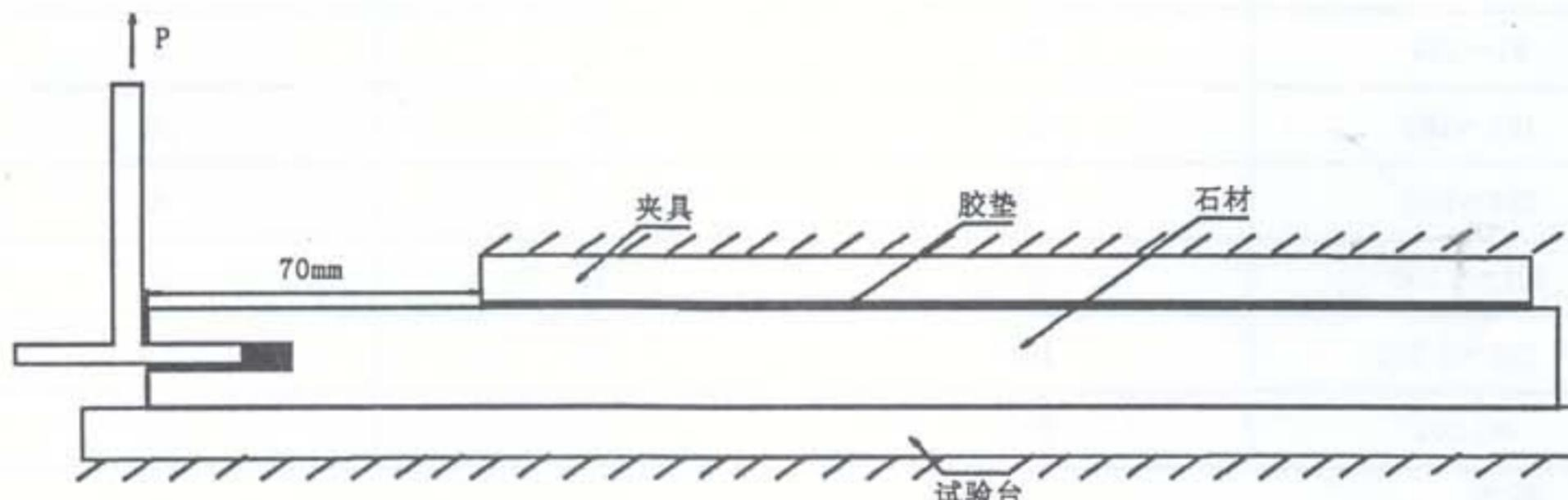
图1 侧面开槽挂装强度试验图
