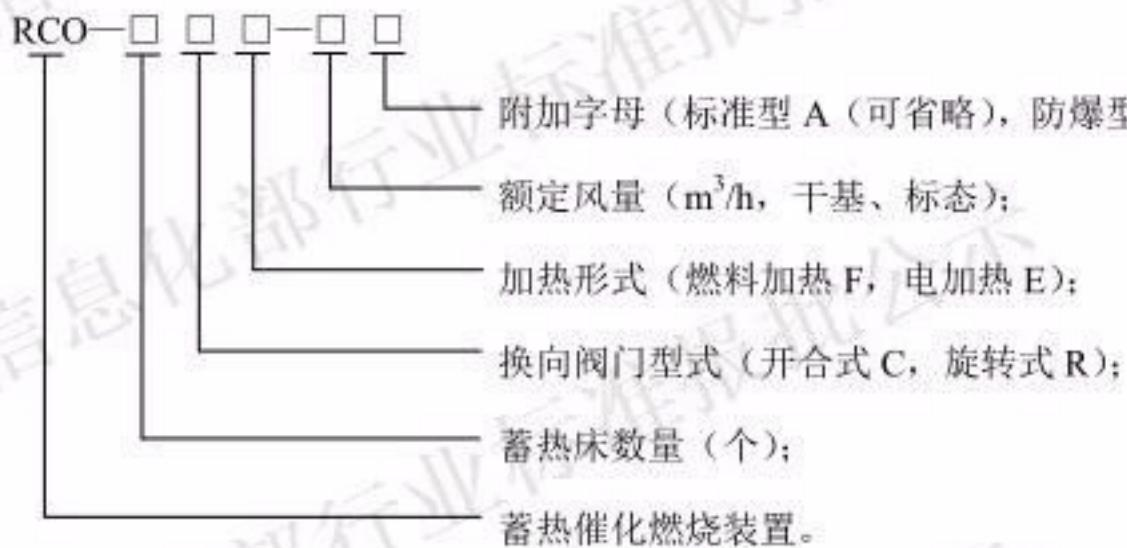
示例：RCO-3CE-5000B 表示：三床式、采用开合阀门、电加热、额定风量为  $5000m^3/h$ （干基、标态）的防爆型 RCO。
