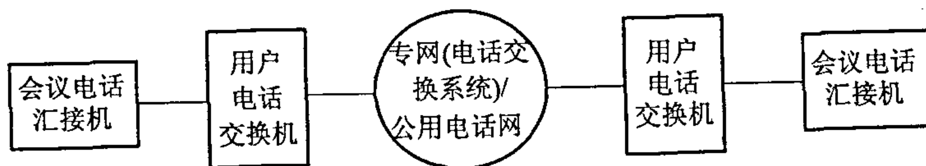
图 4.2.4-1 会议电话系统组网方式 1
