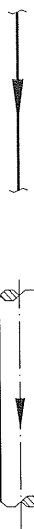
(a)单线管线介质流向表示法 (b)双线管线介质流向表示法
