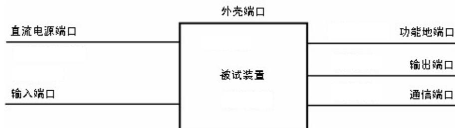
图 1 保护装置的端口示意图
