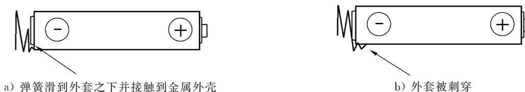
a) 弹簧滑到外套之下并接触到金属外壳
