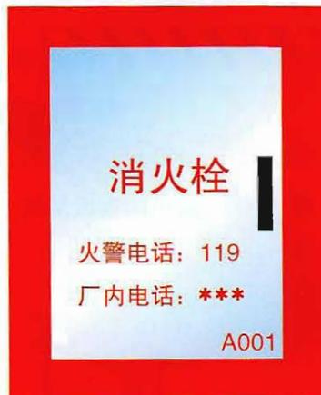
图 B.2 安装有玻璃或其他透明材料的消火栓箱箱门标识示意
