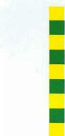
图 A. 58 接地装置警示线示例
