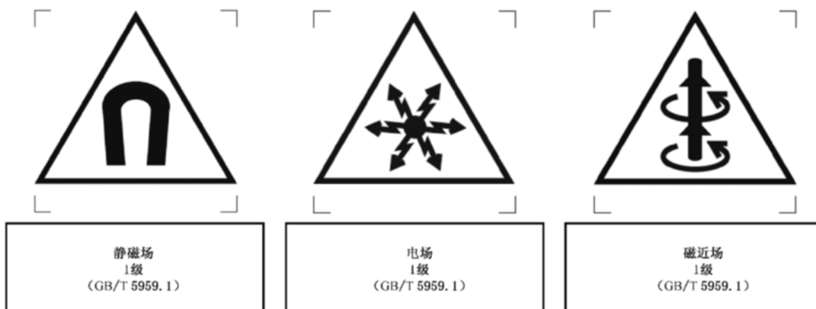
图 F.1 磁场和电场的标记示例
