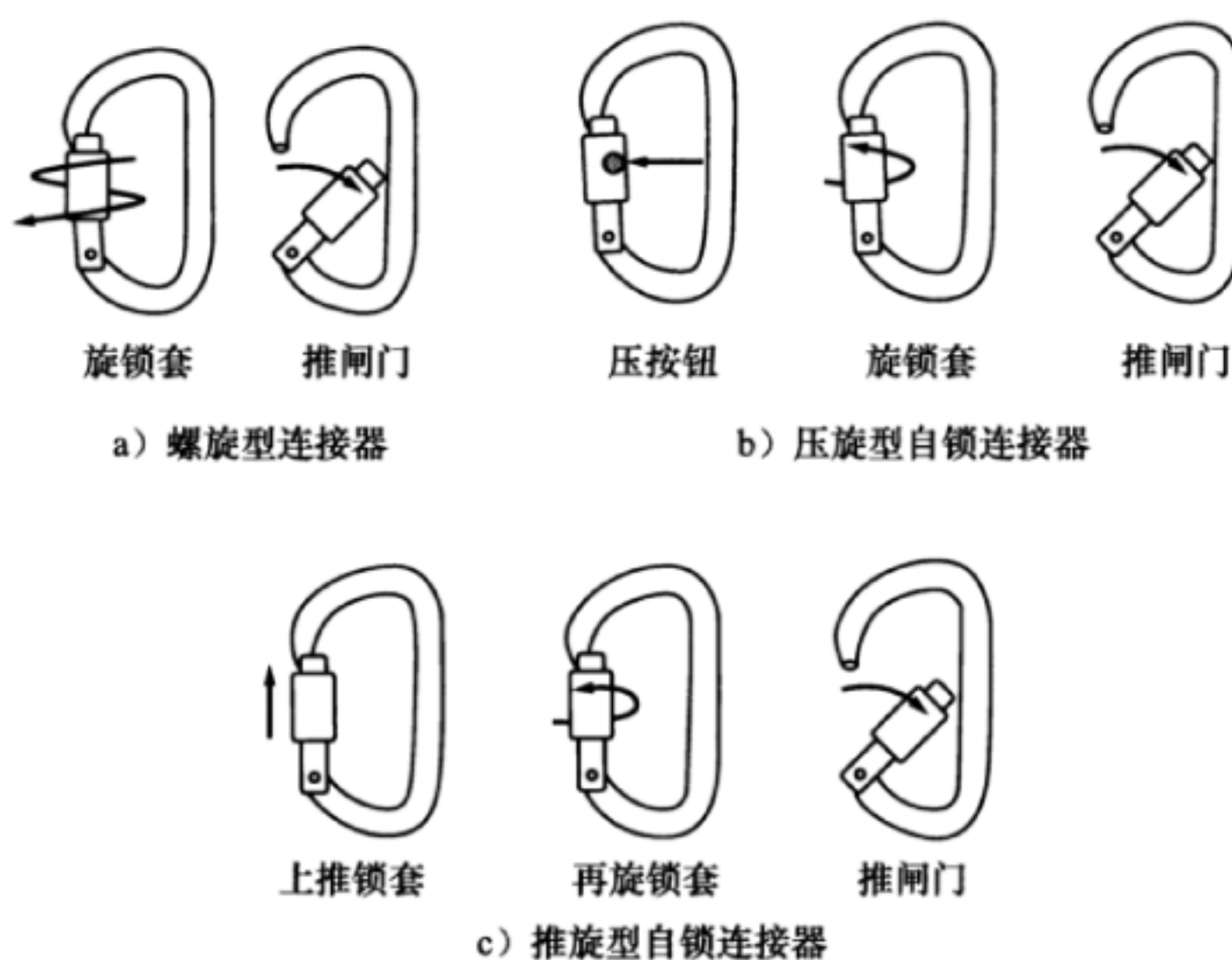
图4 连接器开锁示意图
