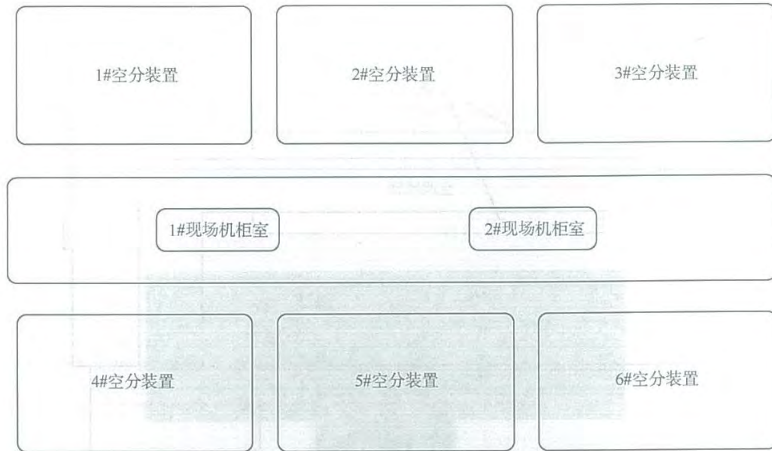
图3 多套空分装置典型的现场机柜室布置
