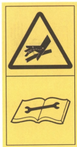
图 C.17 高压液体——避开压力液体——阅读技术手册中适当的维护程序
