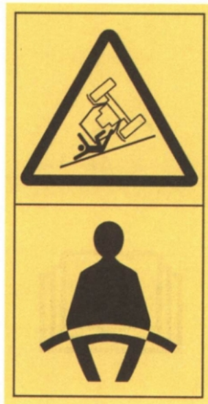
图 C.31 机器滚翻的挤压危害——系安全带
