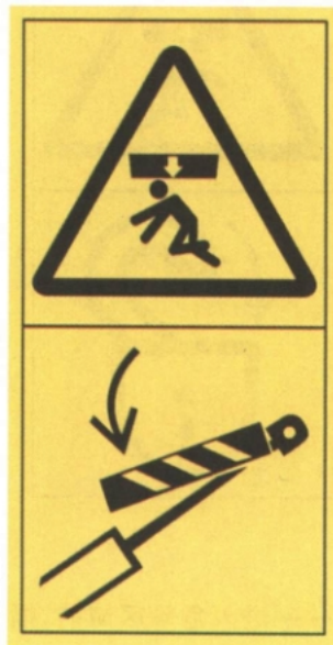
图 C.7 挤压全身——在进入危险区域前,用锁定装置锁住提升液压缸
