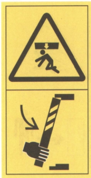
图 C.8 挤压全身——在进入危险区域前,连接好支撑
