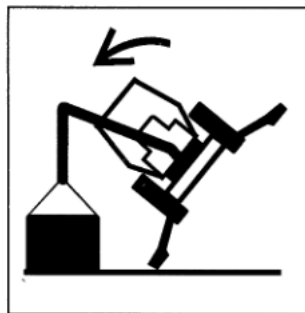
图 A.41 机器侧倾——超载——挖掘装载机
