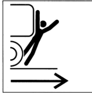
图 D.21 表示整机运动方向的箭头图例
