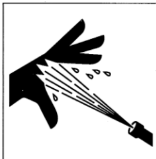
图 A.10 高压喷射——伤蚀人体
