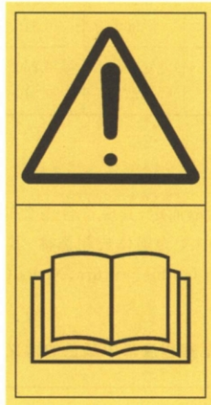
图 10 无文字的机器安全标签——阅读司机手册
