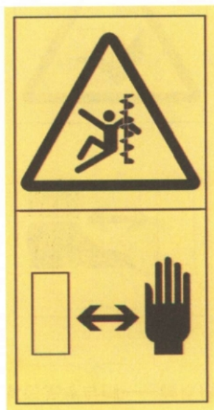
图 C.25 臂或手的螺旋杆缠绕——手和臂与危害保持安全距离
