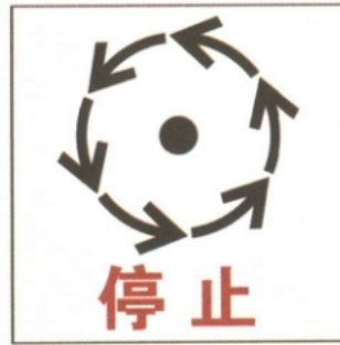
图 B.12 等到所有机器零部件完全停止,才能接触它们
