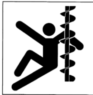
图 A.33 缠绕手和臂——螺旋杆
