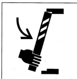
图 B.9 进入危险区域前,连接好支撑
