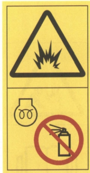
图 C.20 爆炸危害——低温辅助起动的禁用乙醚
