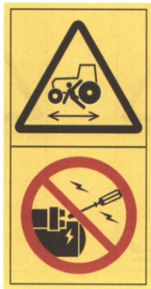
图 C.11 挤压危害——碾压——不要跨接起动发动机
