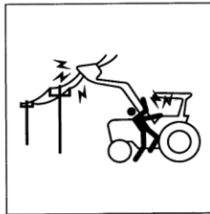
图 A.5 电击/触电——装载机
