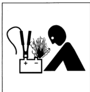
图 A.45 电池爆炸——跨接起动
