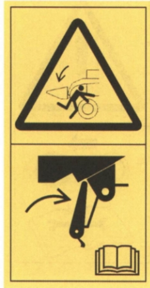
图 C.10 挤压全身——进入危险区域前,连接好安全锁定装置——阅读司机手册
