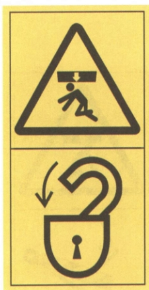
图 C.9 挤压全身——进入危险区域前,插好安全锁定装置
