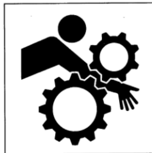
图 A.31 缠绕手和臂——旋转齿轮
