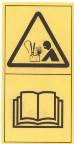
图 C.19 电池爆炸——跨接起动——阅读司机手册
