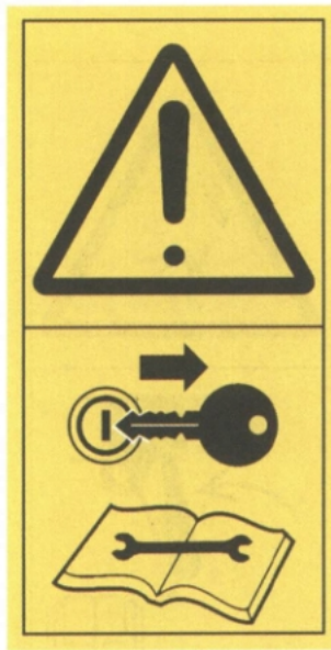
图 C.12 通用安全警告——在进行维修和修理工作前,关闭发动机并取出钥匙
