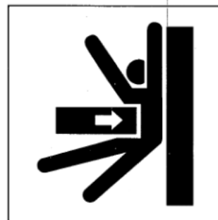
图 A.18 挤压全身——定向挤卡
