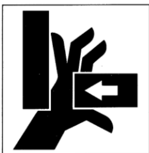
图 A.21 挤压手指或手掌——侧面施加的力
