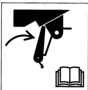
图 B.10 进入危险区域前,连接好安全锁定装置——阅读司机手册
