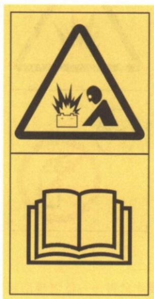
图 C.18 电池爆炸——阅读司机手册
