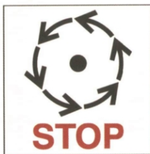
图 NB.5 “等到所有机器零部件完全停止,才能接触它们”停止指示的规避危害英文图示
