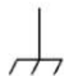
图 6 IEC 60417 的 5020 符号:框架或底架
